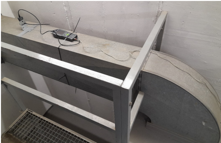
Abbildung 8: Versuchsaufbau am Lüftungskanal
